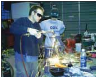
Мал. 67. Різання металу за допомогою ацетиленового пальника
