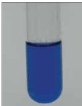
Мал. 76. Забарвлення розчину після взаємодії гліцерину з купрум(II) гідроксидом
