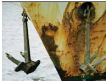
Рис. 32. Корпус судна, покрытый ржавчиной
