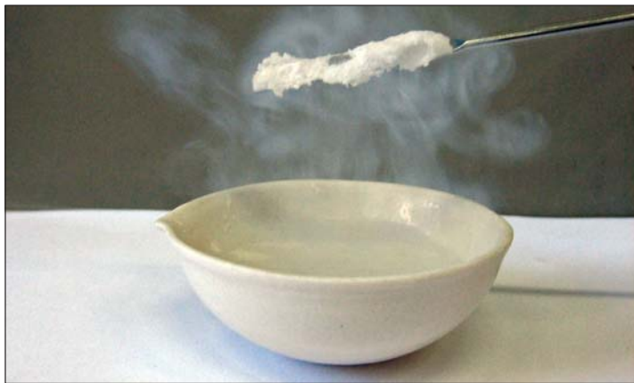
Мал. 20. Реакція оксиду \text{P}_2\text{O}_5 з водою
